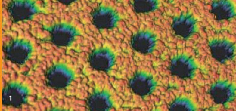
1 Mikrosieb mit Lochdurchmessern von 8  $\mu\text{m}$
